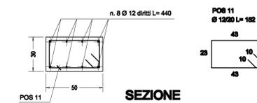
ARMATURA DELLA FONDAZIONE DEL MURO IN CORRISPONDENZA DELLE CADITOIE
