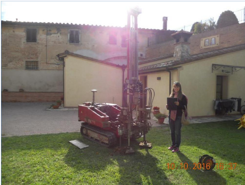
Figura 1: Prova penetrometrica CPT 1
